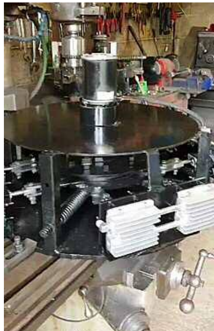
Bobby Amarasingams 3-kW-Lineargenerator, der noch in Fertigstellung ist.
