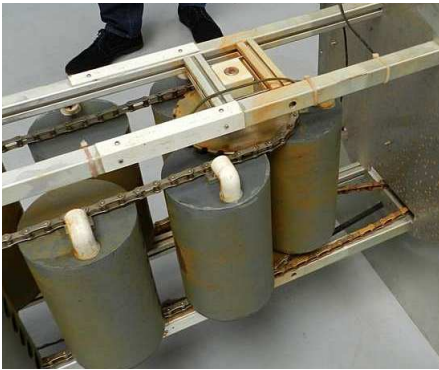
16:51: Oberteil des Paternosters mit der gemeinsamen Zahnkette sowie der Abtriebszahnkette unten rechts.
