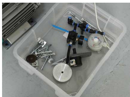
15:53: Kiste mit Druckluftventil, Manometer, Drehgeber u.a. Kleinteilen.
