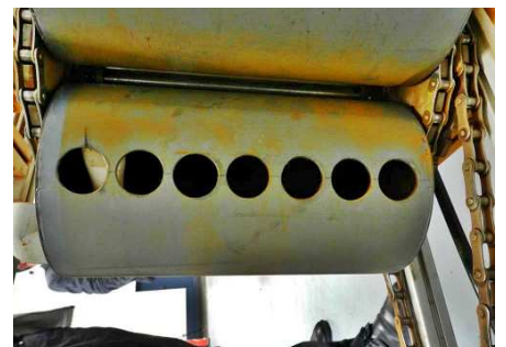
16:55: Auftriebsbehälter mit je sieben Löchern zum Wasserein-/austritt.
