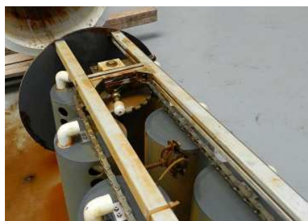
16:54: Unterteil des Paternosters mit dem Zahnrad mit den drei Ventilen.
