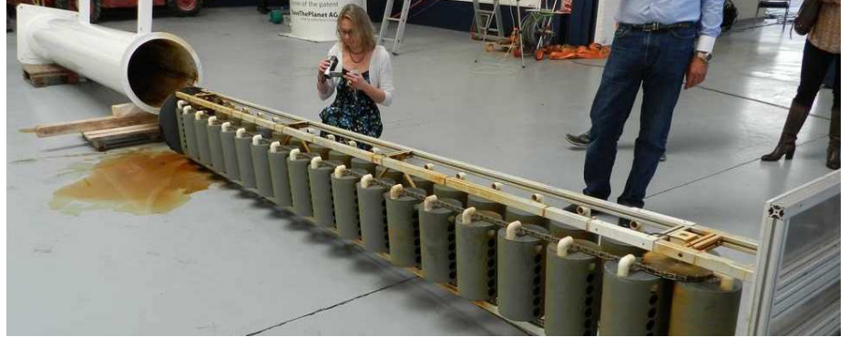
16:52: Der 4,5 m hohe Paternoster des Auftriebskraftwerkes besteht aus insgesamt 36 zylindrischen Behältern mit einem Volumen von jeweils rund 7 Litern, die sich im Betrieb mit einer Geschwindigkeit von 0,24 m/s bewegen.
